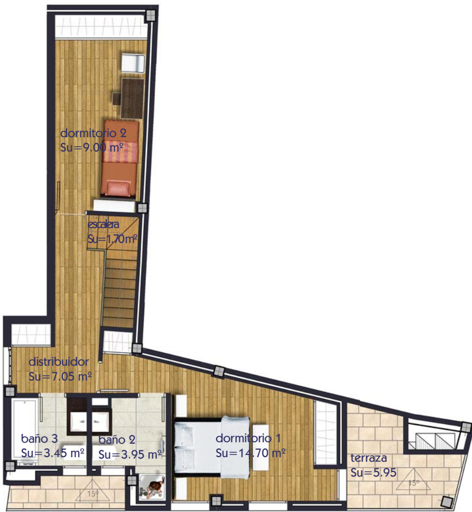
VIVIENDA TIPO -A- PLANTA BAJO CUBIERTA (B/C) escala 1/100
